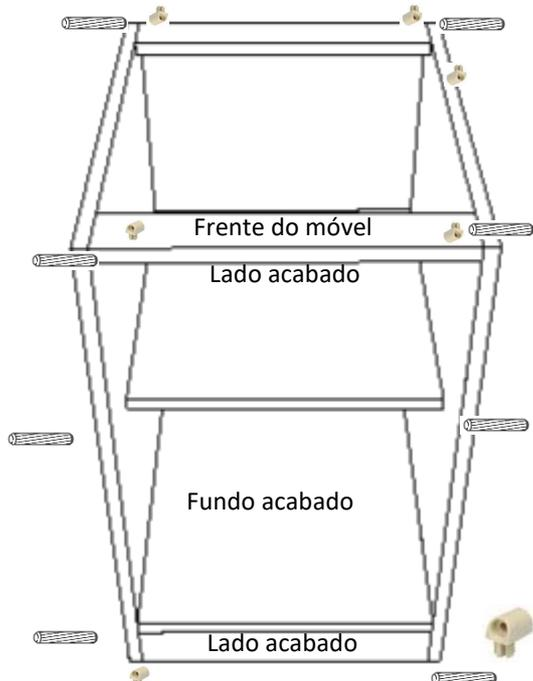
4. Faça a fixação dessas laterais utilizando os trapézios e os parafusos 4x25 colocados nos rodapés;
