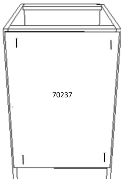
7. Deite o caixote de frente. Posicione o traseiro sobre as costas. Alinhe o canto superior esquerdo a 2mm de distância do rodapé superior e da lateral. Coloque 2 pregos 10x10 para fixar em cada extremidade. Alinhe a outra extremidade e pregue da mesma forma. Após garantir o correto alinhamento coloque um prego a cada 10 cm aproximadamente para finalizar;
