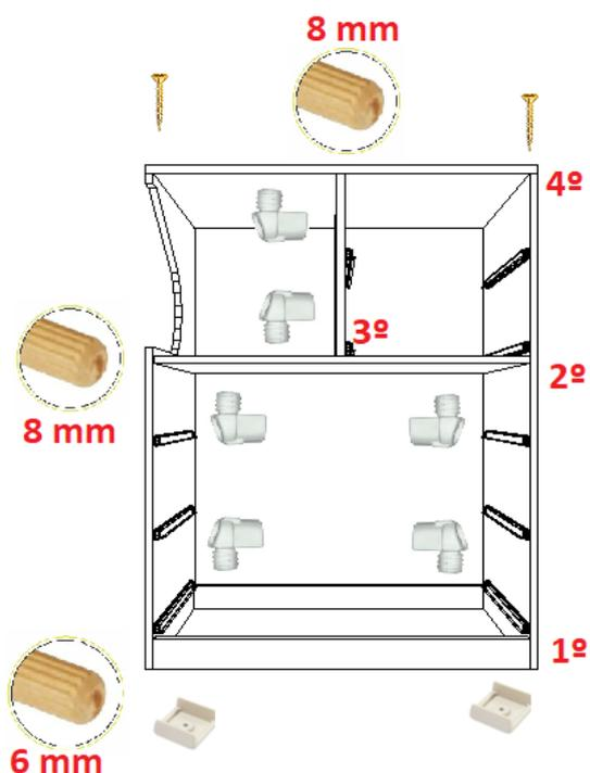
2. Parafuse os pezinhos, 2 em cada extremidade inferior (lado oposto ao das cavilhas). Use os parafusos 3,5x14. Deixe uma distância de 5cm de cada ponta;
