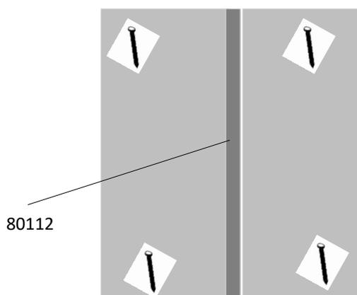
14. Deite ambos caixotes, superior e inferior de frente e posicione um dos dois traseiros sobre as costas. Alinhe o canto superior esquerdo a 2mm de distância da base superior e da lateral. Coloque 2 pregos 10x10 para fixar em cada extremidade. Use o perfil H para unir ao outro traseiro. Alinhe a outra extremidade e pregue da mesma forma. Após garantir o correto alinhamento coloque um prego a cada 10 cm aproximadamente para finalizar.
