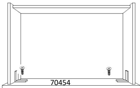
6. Apoie a frente da gaveta no chão e encaixe o quadro da gaveta que foi montado no item anterior. O encaixe se dará pelos pinos da cantoneira nos furos da frente de gaveta. Use 1 parafuso modelo 3,5x14mm em cada cantoneira para melhorar a fixação;
