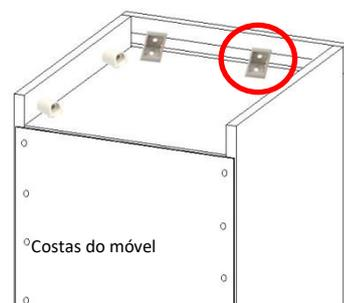
16. Fixe o frontal à base superior utilizando as três cantoneiras plásticas e os parafusos 3,5x14 conforme ilustrado (divida o espaço entre as três). Tenha atenção de posicionar o frontal de modo que ele fique rente às laterais do móvel tanto na altura como na largura e com a fita metálica virada para baixo;
