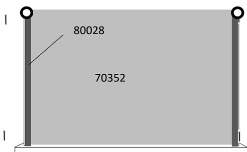
7. Posicione o fundo de gaveta de modo que ele encaixe na frente da gaveta. Alinhe rente às laterais e à posterior de gaveta. Coloque 2 pregos 10x10 para fixar. Alinhe a outra extremidade e pregue da mesma forma. Finalize com um prego a cada 10 cm aproximadamente por toda lateral e posterior de gaveta;
