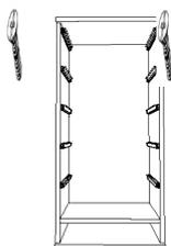
1.9 Parafuse a base (lado sem acabamento) às laterais utilizando os parafusos 3,5x40 onde estão as furações;
