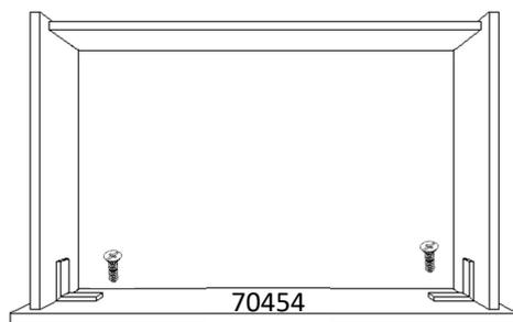
1.14 Apoie a frente da gaveta no chão e encaixe o quadro da gaveta que foi montado no item anterior. O encaixe se dará pelos pinos da cantoneira nos furos da frente de gaveta. Use 1 parafuso modelo 3,5x14mm em cada cantoneira para melhorar a fixação.
