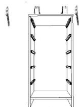
1.10 Aproveite a posição do móvel (de cabeça para baixo) e fixe os rodízios na base utilizando os parafusos 3,5x14: 2 em cada extremidade a 5cm da base inferior.
