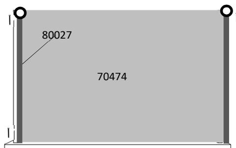
1.15 Posicione o fundo de gaveta de modo que ele encaixe na frente da gaveta. Alinhe rente às laterais e à posterior de gaveta. Coloque 2 pregos 10x10 para fixar. Alinhe a outra extremidade e pregue da mesma forma. Finalize com um prego a cada 10 cm aproximadamente por toda lateral e posterior de gaveta.
