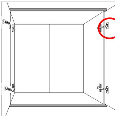
1.12 Parafuse as dobradiças já montadas (com calços) nos furos da porta com os parafusos 3,5x14;
