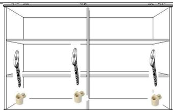
1.7 Utilize os parafusos 4x25 para fixar à base os 3 trapézios fixados em cada lateral;
