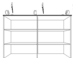
1.9 Aproveite a posição do móvel (de cabeça para baixo) e fixe os rodízios na base utilizando os parafusos 3,5x14: 2 em cada extremidade a 5cm da base e 2 no centro, na direção da divisória central a 5 cm das bordas da base.
