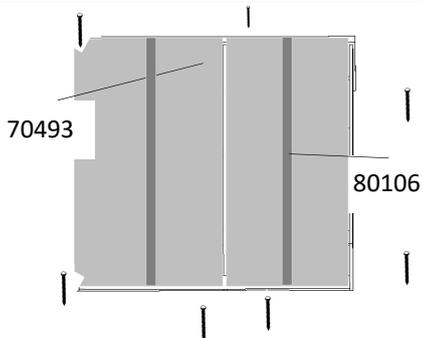
1.10 Deite o móvel de frente com as costas para cima. Posicione os traseiros sobre ele dividindo o espaço. Alinhe o canto superior esquerdo a 2mm de distância do tampo e da lateral. Coloque 2 pregos 10x10 para fixar em cada extremidade. Alinhe a outra extremidade e pregue da mesma forma. Use os perfis H para unir os traseiros. Finalize com pregos a cada 10cm aproximadamente;
