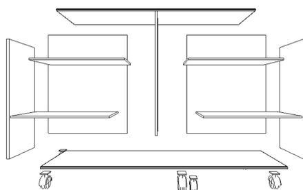
1.6 Coloque cola nos demais furos da outra base (inferior, com o lado acabado virado para baixo) e fixe-a, encaixando os furos nas cavilhas. Tenha atenção em colocar as laterais com os furos pinos virados para dentro;
