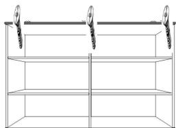
1.8 Parafuse a base (lado sem acabamento) às laterais utilizando os parafusos 3,5x40 onde estão as furações;
