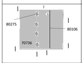
1.9 Deite o móvel de frente com as costas para cima. Posicione o traseiro maior da lateral até a divisória. Alinhe o canto superior esquerdo a 2mm de distância do tampo de da lateral. Coloque 2 pregos 10x10 para fixar em cada extremidade. Alinhe a outra extremidade e pregue da mesma forma;
