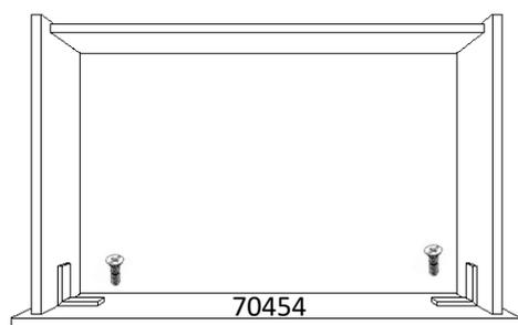
15. Apoie a frente da gaveta no chão, sobre o papelão e encaixe o quadro da gaveta nela. O encaixe se dará pelos pinos da cantoneira nos furos da frente de gaveta. Use 1 parafuso modelo 3,5x14mm em cada cantoneira para melhorar a fixação.
