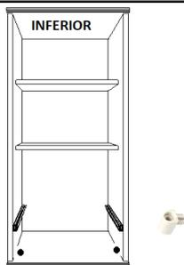
6. Encaixe as laterais na base superior (face acabada virada para cima), utilizando-se das cavilhas já colocadas como guia- com as corrediças viradas das laterais para o lado interno do móvel;
