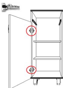
11. Encaixe as dobradiças na porta e parafuse-as usando os parafusos 3,5x14 mm.
